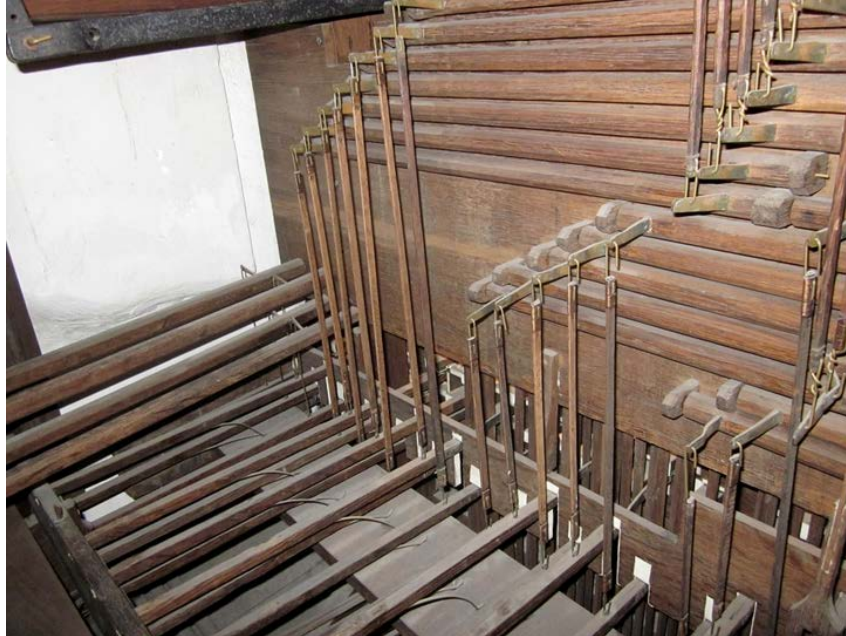
Een wellenbord uit het midden van de zeventiende eeuw, hier voor de verbinding tussen pedaal en manuaal (Amsterdam, Nieuwe Kerk, transeptorgel).
