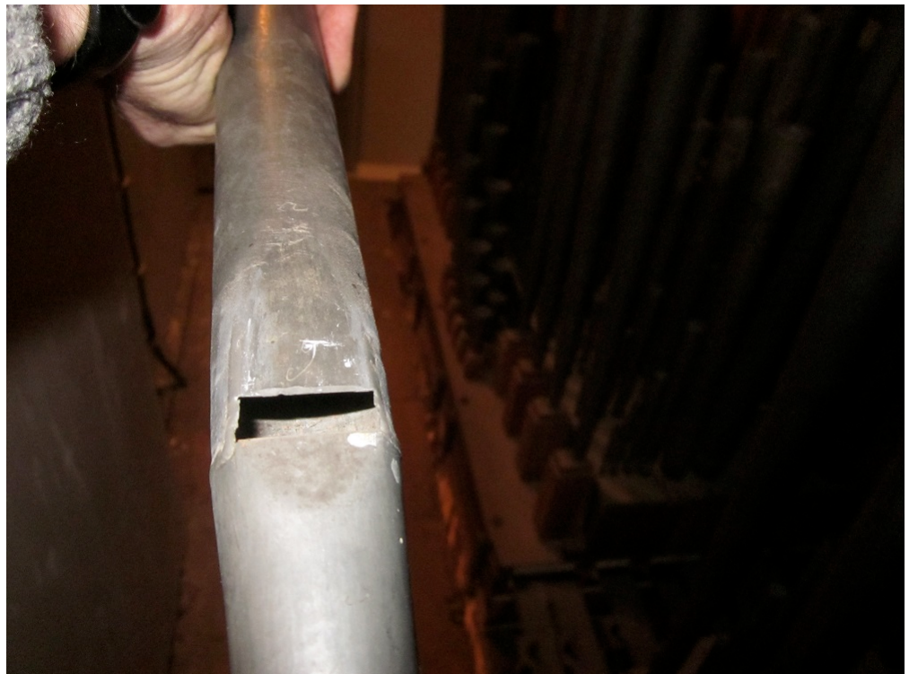
Deze pijp is, wellicht als gevolg van onvoorzichtig stemmen, vervormd bij de kaken, iets wat de klank ongunstig beïnvloedt.
