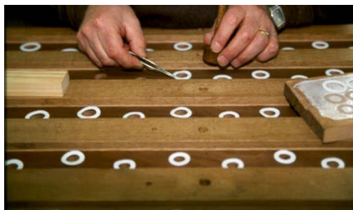
Om de laden beter bestand te maken tegen schommelingen in temperatuur en vochtigheid, worden ze, na te zijn hersteld, voorzien van stoffen ringen.
