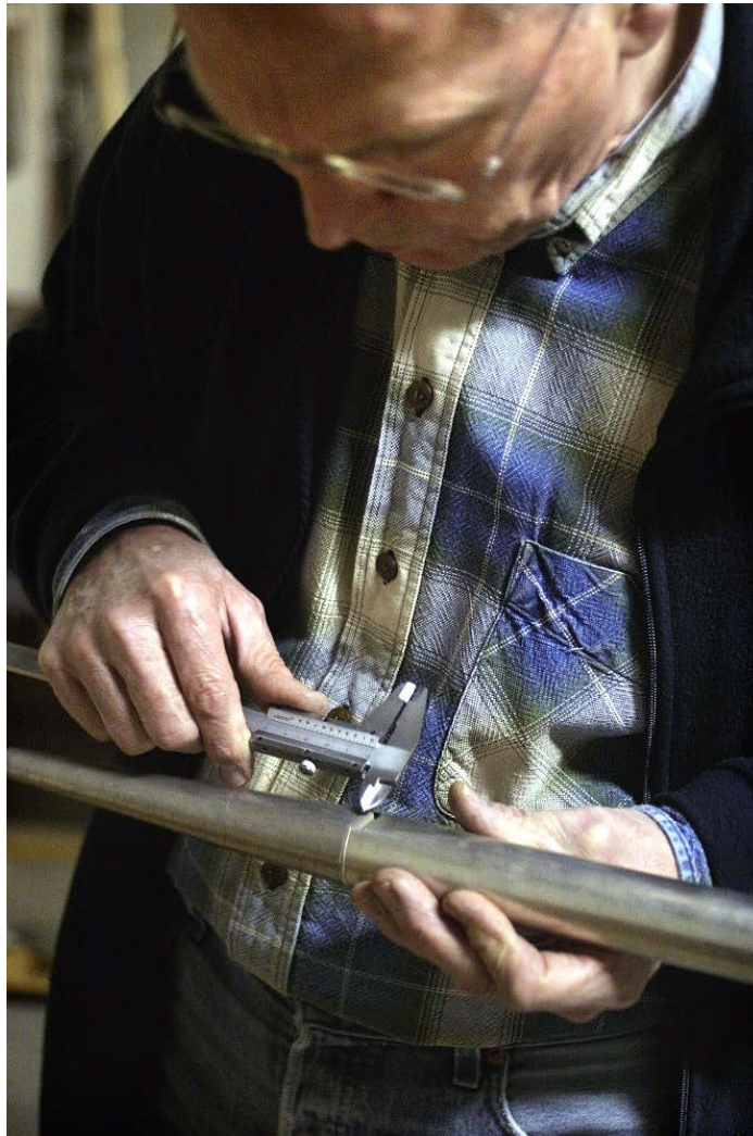
Meten en documenteren van pijpen geeft inzicht in de klank die de oorspronkelijke bouwers van het orgel voor ogen heeft gestaan.
