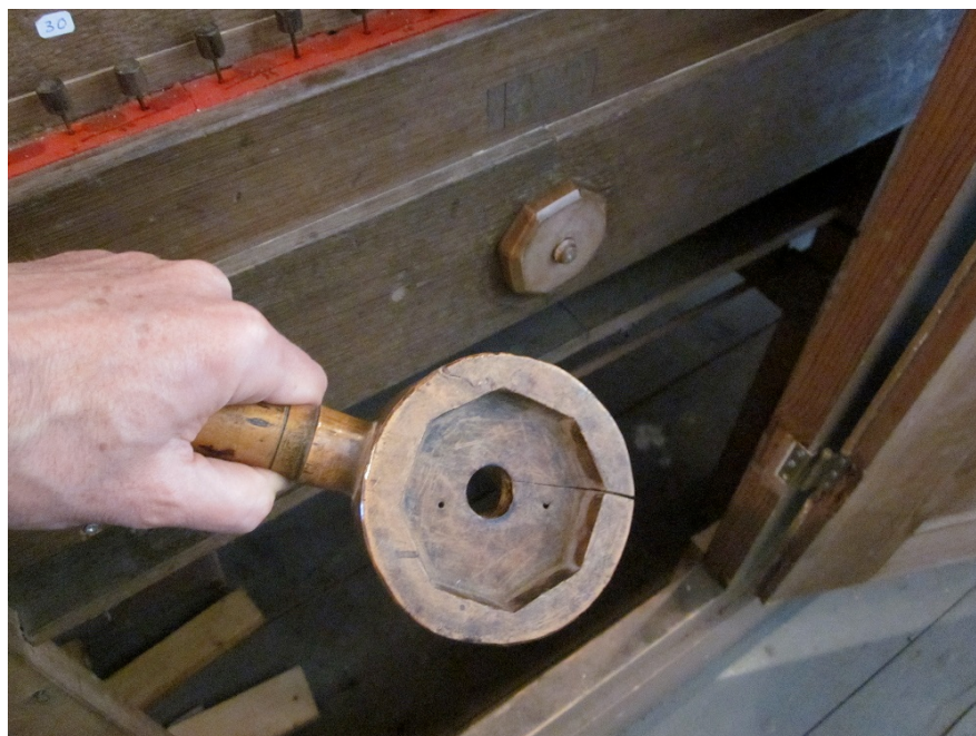
Bij dit orgel bleef een uniek stuk gereedschap bewaard: een palmhouten sleutel voor het los- en vastdraaien van de achthoekige moeren waarmee de voorslagen op hun plaats worden gehouden (Abbekerkerk).
