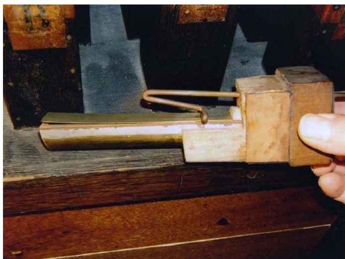
De zgn. kop van een Trompetpijp, met keel, tong en stemkruk. Het vlak van de keel is voorzien van een dun laagje leer. Het metaal eronder is geoxideerd, waardoor dat leer niet meer vlak ligt, en de pijp niet meer aanspreekt of een slechte klank heeft.
