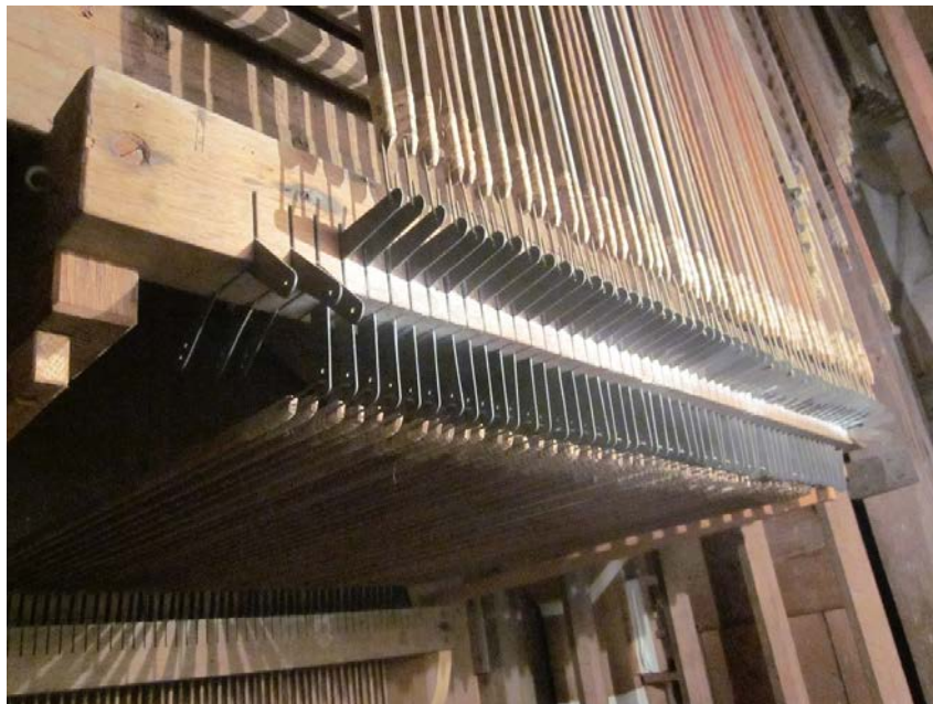
Voor het om een hoek leiden van de toetsbeweging dient een zgn. winkelhaak. Een rij van zulke winkelhaken is vastgehecht aan de winkelhaakbalk.
