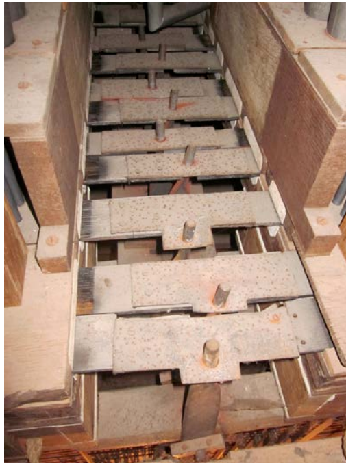
Tussen twee laden zijn de slepen verbonden met ijzeren platen, waarop de registermechaniek aangrijpt. Alles is vrij sterk vervuild en geoxideerd.
