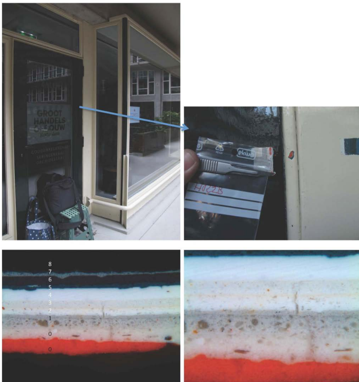
Fig. 11. Voorbeeld van de documentatie van een verfmonsterplaats en verfmonster. Verkennend kleurhistorisch onderzoek Groot Handelsgebouw Rotterdam.
