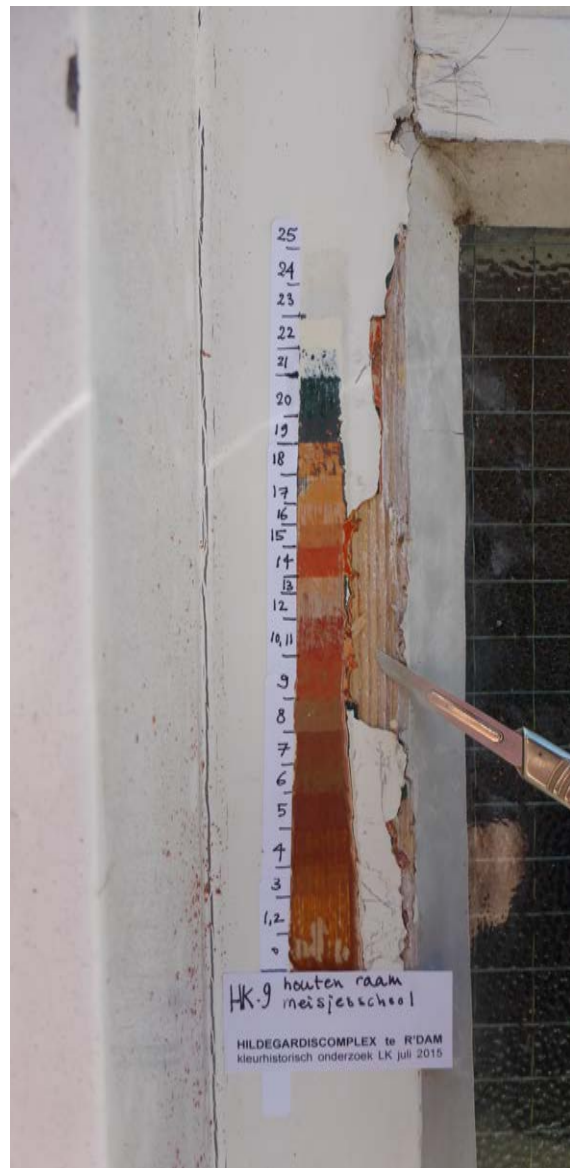
Fig. 4. Voorbeelden van een kleurentrap of stratigrafie. Links op een kozijnstijl van het Duivenhuis in Artis te Amsterdam, rechts op een raam van de Hildegardis meisjesschool te Rotterdam.
