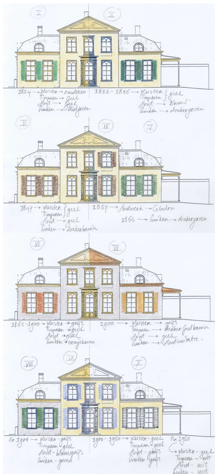
Fig. 10. Schematische tekeningen met daarop een weergave van het veranderen van de kleuren op het exterieur van de Sluishoef te Bilthoven van 1824-1950. Het verkennend kleurhistorisch onderzoek bracht hier 10 afwerkstadia aan het licht.
