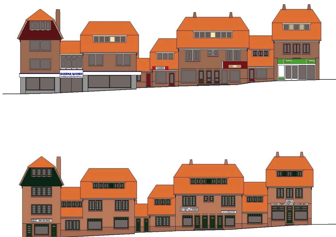
Fig. 1. Twee schematische gevelbeelden van een ensemble in tuindorp 'de Geitenkamp' te Arnhem. Boven het bestaande kleurbeeld en daaronder een hypothetische reconstructie door het architectenbureau op basis van het uitgevoerde verkennende kleurhistorisch onderzoek.
