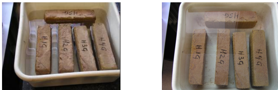
Figuur 5. Onderdompeling in twee fasen: eerst gedeeltelijk (links) zodat lucht uit het monster kan ontsnappen, vervolgens geheel (rechts).
