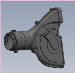
TNO ontwerp 2019 De afzuigkap is recent herontworpen. De emissie is (nog) verder geminimaliseerd
