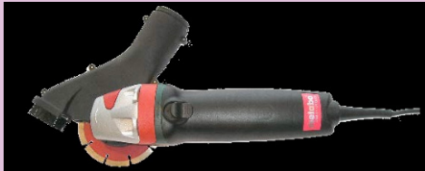
Afzuigkap voor een haakse slijper Haakse slijper te gebruiken voor het inslijpen van natuursteen. Afzuigkap met stofzuiger is zeer effectief (reductiefactor: > 5.000 maal), maar in de praktijk kan de afzuigkap het werk belemmeren
