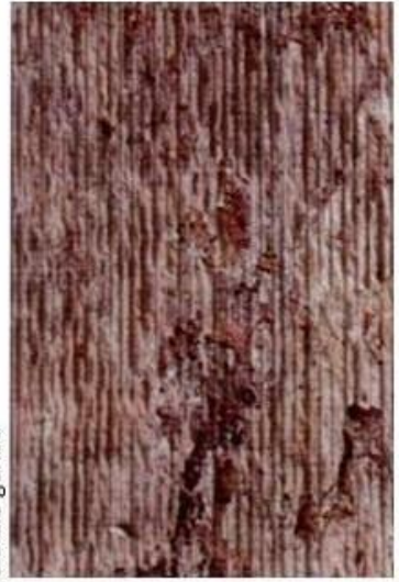
2.1.2.2 machinaal ingezaagd en gehakt
